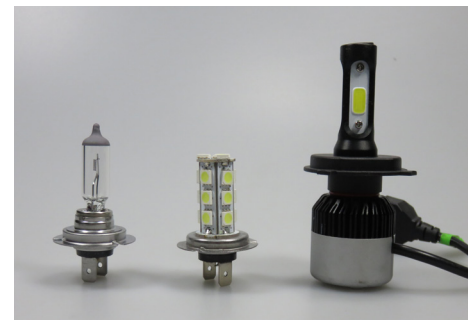
De gauche: lumière à halogène conventionnel, LED-H7, LED H4 (Image TCS)
